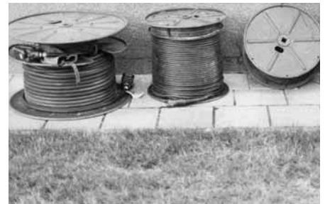
Haspels met kabel. Van links naar rechts RL-3008 met 20 DA; RL-3005 met S4 en RL-159/U met WD-1/TT.
